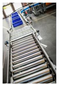
Problemstellung: Dezentral gesteuerte Fördertechniksysteme wie der FlexFörderer skalieren nicht, was dazu führt, dass mit steigender Anzahl an Fördermodulen (größer 100) Verzögerungen bei der Kommunikation auftreten. Dies hat negative Auswirkungen auf den Durchsatz, da z.B. die Dauer für Transporte zunimmt.
