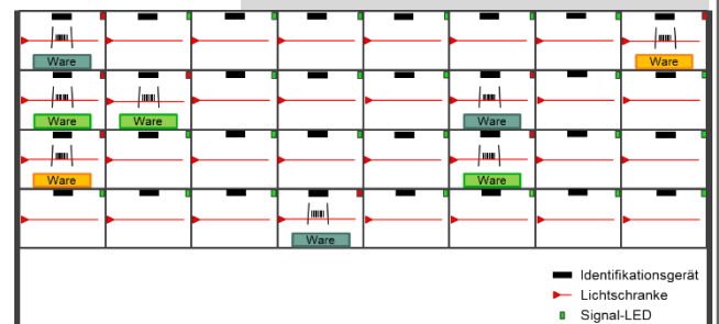
Abbildung 2 – Skizze Aufbau Regalsystem
