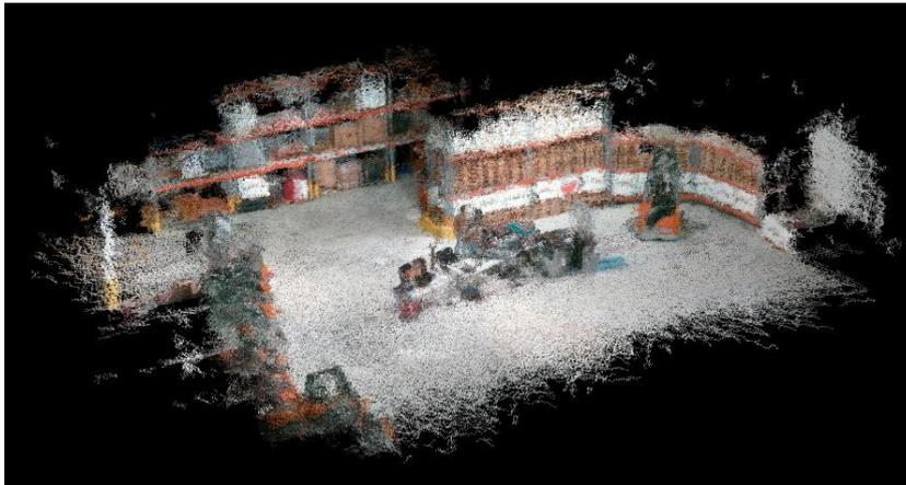
**Rahmen:** Das [ARIBIC Projekt](#) ist ein deutsch-kanadischen Kooperationsprojekt zur Erforschung des Einsatzes von KI Methoden in Lagerhäusern. Ziel ist es, die Navigationssensorik auf fahrerlosen Transportfahrzeugen zur Informationsgewinnung über den Zustand eines Logistikzentrums zu verwenden. Am Ende soll ein lebendiger digitaler Zwilling des Logistikzentrums entstehen.
