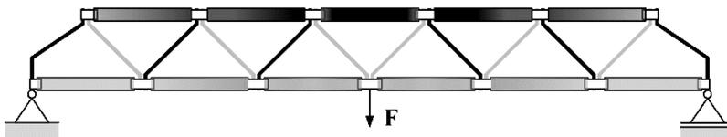
Die neue modulare Kranbrücke ist in Anlehnung an eine zweidimensionale Fachwerkkonstruktion aufgebaut, zusammengesetzt aus Ober- und Untergurt, die über diagonale und senkrechte Bleche miteinander verbunden werden.
